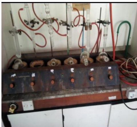
fig 3.5A:Kjeldahl digestion Apparatus
